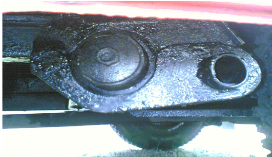
Alte Ausführung Achsaufnahmen
